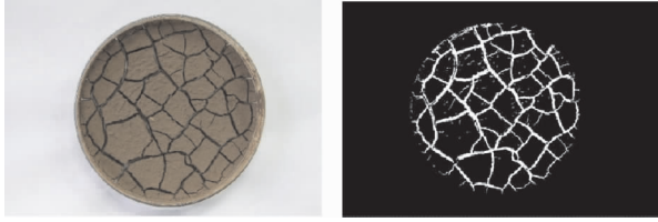
图 16 河伯所遗址试样开裂图
